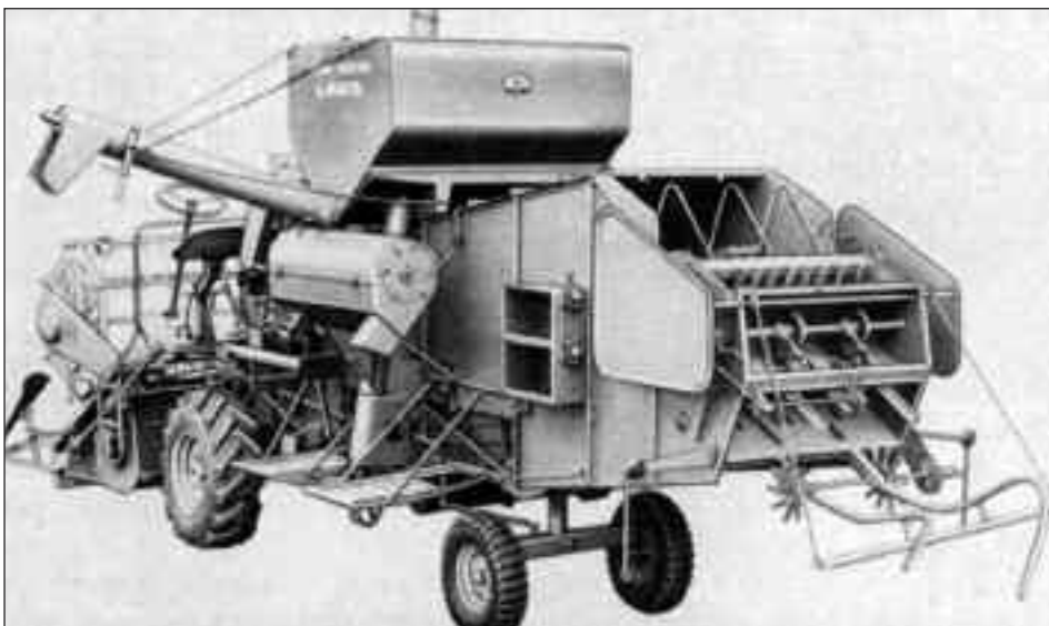
Selbstfahrender Mähdrescher John Deere-Lanz mit Korntank, Arbeitsbreite 2,40 m, 50 PS, 25 dz/Stunde.
