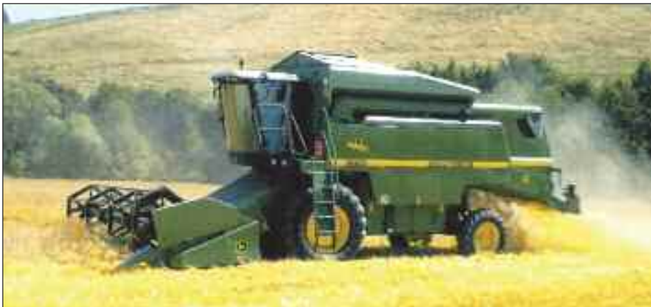
Mähdrescher der Familie Günther Strube vorm Heister: John Deere 2256 mit 4,20 m Arbeitsbreite, 260 PS, 7000 Liter Korntank.
