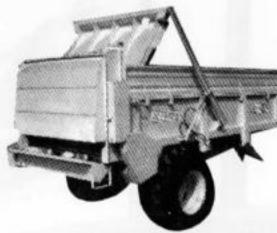
MC 105 mit 7,5 t Nutzlast, 4,50 m x 2,10 m x 0,60 m
