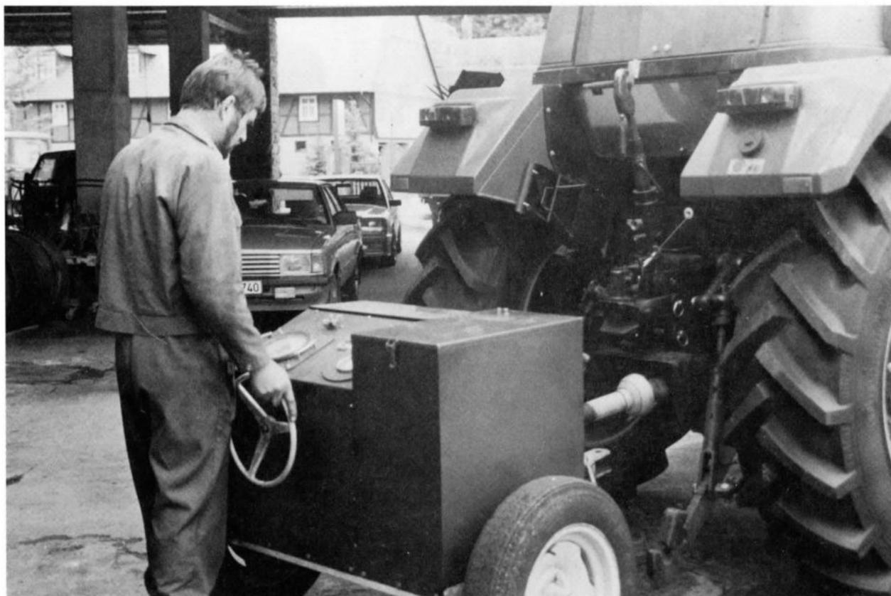
*Zur Leistungs- und Verbrauchsmessung für Dieselmotoren steht für unsere Kundschaft ein Dynamometer (Motorbremse) zur Verfügung. Fehler können so lokalisiert und Reparaturen effektiv vorgenommen werden. Unser Foto zeigt die Motorbremse im praktischen Einsatz an einem Schlepper.*
