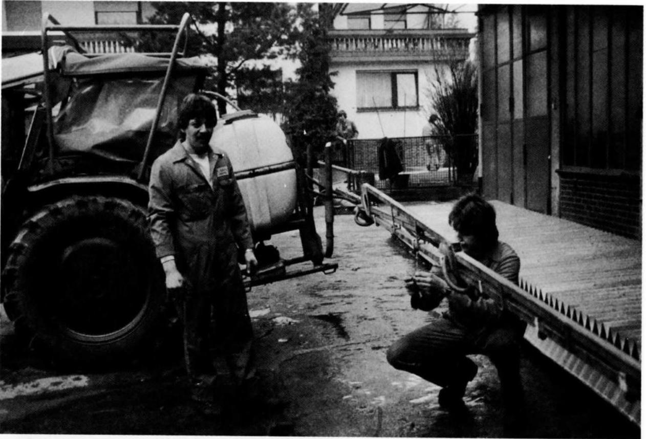
*Momentaufnahmen von der jährlichen Spritzenprüfung auf unserem Firmengelände: An der Feldspritze wird die Pumpleistung kontrolliert, die Manometer getestet, die Ausbringmenge ausgelitert und das Strahlbild eingestellt. Vor dem abschließenden Gespräch mit dem Chef über das Prüfungsergebnis (unten) gibt Wilhelm Brandau sein Fachwissen und Erfahrungswerte an Auszubildende weiter.*
