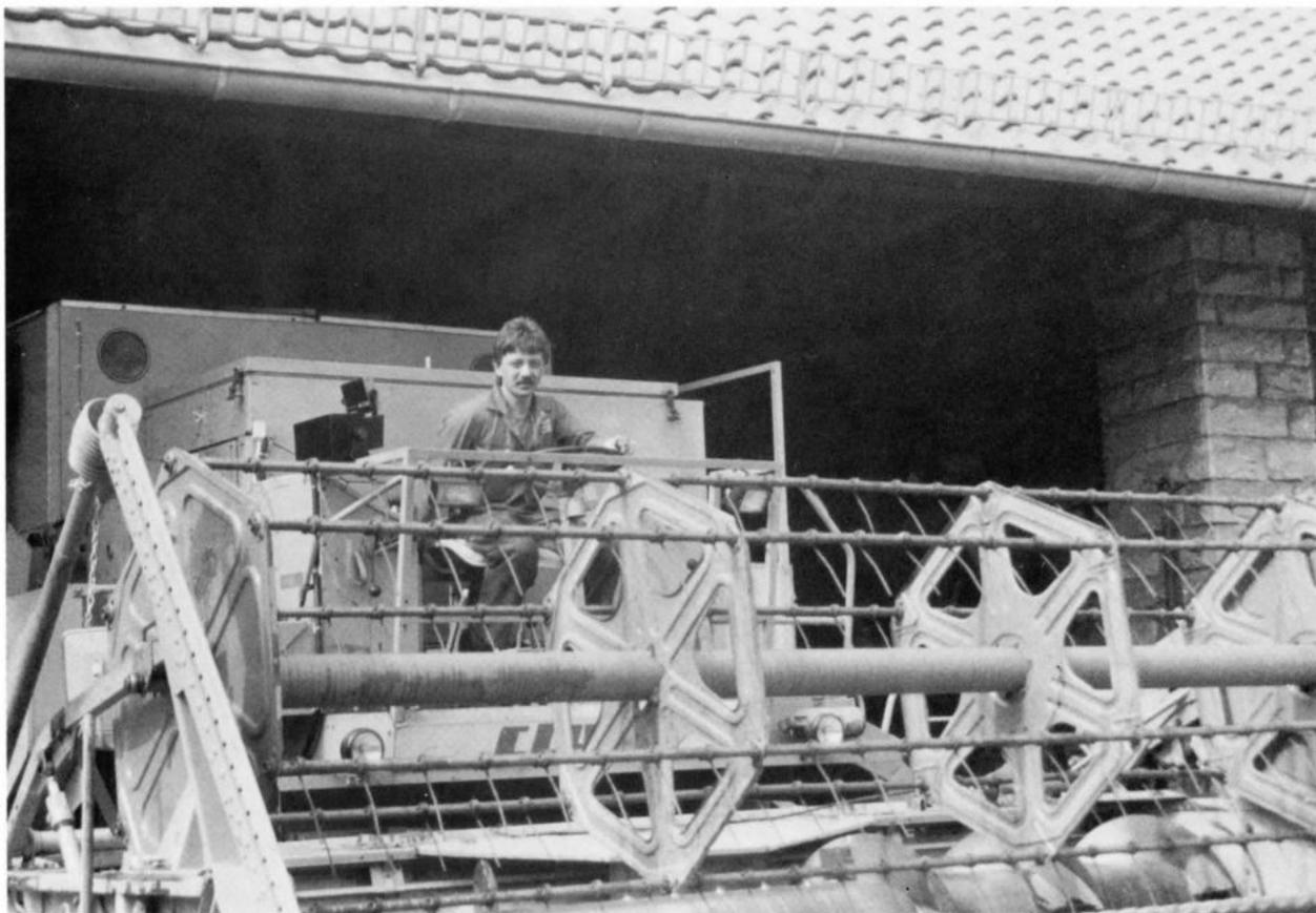
*Probelauf des neuen Rapsschneidwerks am Dominator 85, der als Lohnmaschine in unserem Betrieb eingesetzt wird.*
