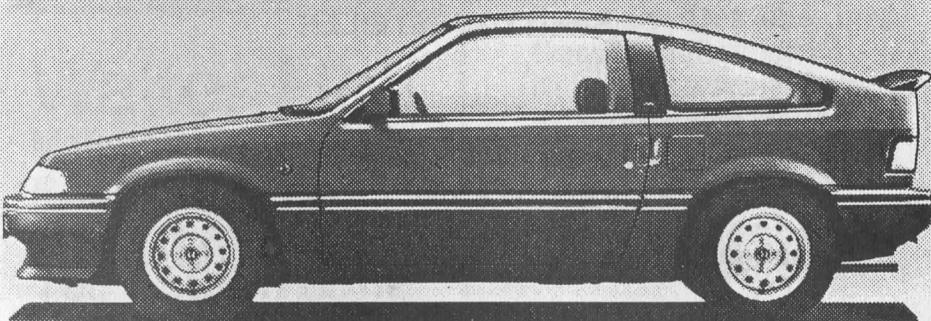
Die Fahr-Maschine im Detail: Neuentwickelter Motor mit 12 Ventilen, Hubraum (Steuerformel) 1477 cm<sup>3</sup>, Leistung 74 kW (100 PS) bei 5750 1/min, elektronische, programmierte Kraftstoffeinspritzung PGM-Fi, Höchstgeschwindigkeit 190 km/h, Beschleunigung 0–100 km/h: 8,9 sec, 5-Gang-Getriebe, elektrisches Stahlschiebedach, Sport-Schalensitze.
